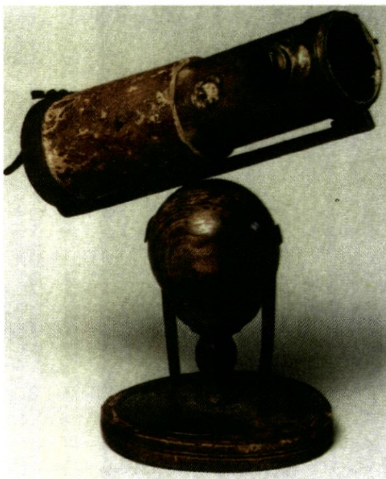
Εικόνα 2.19: Το κατοπτρικό τηλεσκόπιο του Νεύτωνα. Οι ακτίνες του φωτός συλλέγονται από ένα κοίλο πρωτεύον κάτοπτρο. Συγκλίνουν προς την κύρια εστία του και κατευθύνονται από ένα επίπεδο δευτερεύον κάτοπτρο προς τον προσοφθάλμιο φακό.
