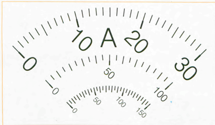
Εικόνα 2.16 Κλίμακα αμπερομέτρου τριών περιοχών μετρήσεων
