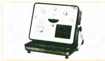
Γέφυρα μέτρησης R.L.C
