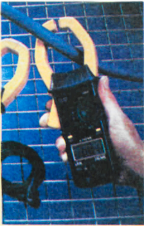
Εικόνα 2.19.γ Μετασχηματιστές εντάσεως.
