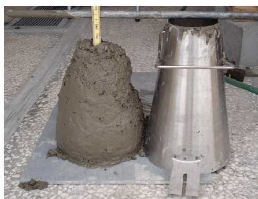
Φωτογραφία 8.22 & 8.23 Κάθιση 10 ης και 11 ης παρτίδας πριν & μετά την χρήση υπερρυστοποιητή.
