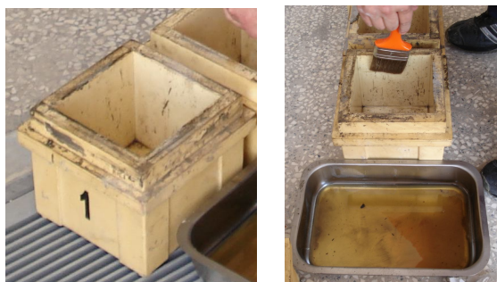
Φωτογραφίες 8.27 & 8.28 Μήτρα δοκιμίου & λάδωμα της μήτρας με ορυκτέλαιο.
