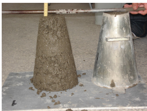
Κάθιση 10 ης και 11 ης παρτίδας πριν & μετά την χρήση υπερρευστοποιητή.
