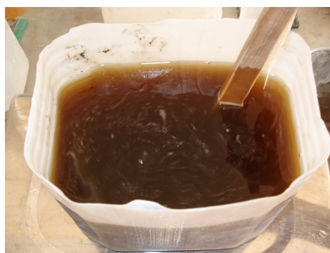
Φωτογραφία 8.5 & 8.6 Ζύγιση ποσότητας υπερρυστοποιητικού για 3 δοκίμια & ανάμιξη του με το νερό.
