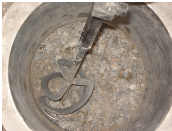
Φωτογραφίες 8.16 & 8.17 Αναμικτήρας & ξηρή ανάδευση αδρανών στο δοχείο.
