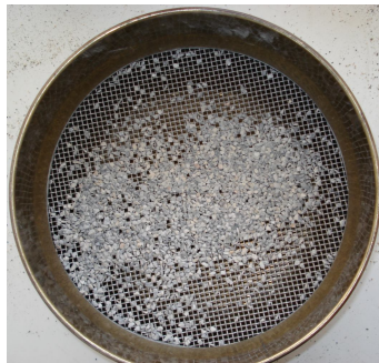
Φωτογραφίες 8.10 & 8.11 Συγκρατούμενο βάρος στα κόσκινα 4 & 0,25 (ριζάκι & άμμος ποταμού).
