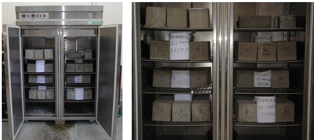
Φωτογραφία 8.41 Δοκίμια μέσα στον θάλαμο συντήρησης.
