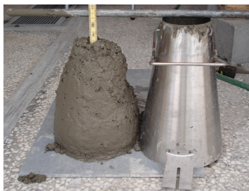
Κάθιση 10 ης και 11 ης παρτίδας πριν & μετά την χρήση υπερρευστοποιητή.
