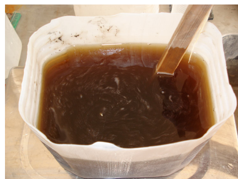
Ζύγιση ποσότητας υπερρυστοποιητή για 3 δοκίμια & ανάμιξη του με το νερό.
