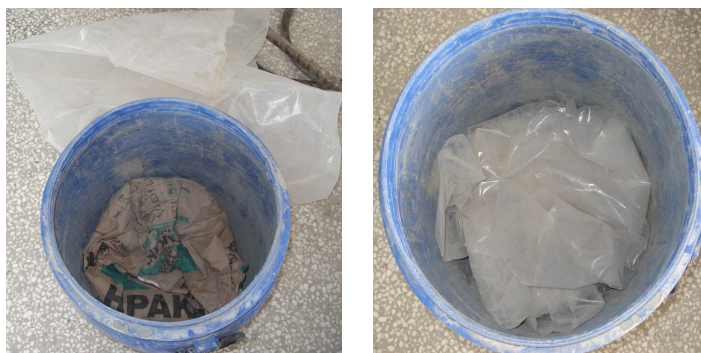
Φωτογραφία 8.2 Αποθήκευση του τσιμέντου.
