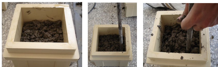
Φωτογραφίες 8.30 & 8.31 1 η στρώση μήτρας & συμπύκνωση της με ράβδο.
