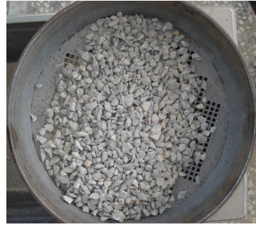
Φωτογραφίες 8.8 & 8.9 Συγκρατούμενο βάρος στα κόσκινα 16 & 8 (σκύρα & γαρμπίλι).
