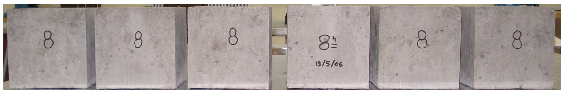
Φωτογραφία 8.40 Αναγραφή στα δοκίμια αριθμού παρτίδας & ημερομηνίας παρασκευής τους.
