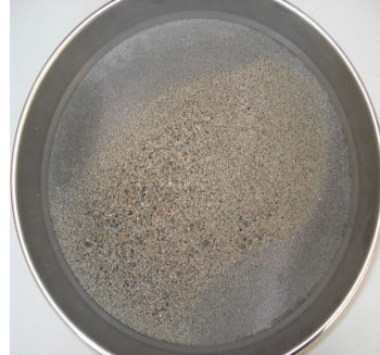
Φωτογραφίες 8.10 & 8.11 Συγκρατούμενο βάρος στα κόσκινα 4 & 0,25 (ριζάκι & άμμος ποταμού).
