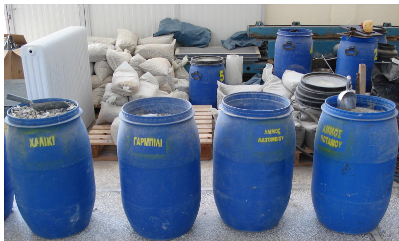
Φωτογραφία 8.3 Αδρανή υλικά στο εργαστήριο σκυροδέματος.
