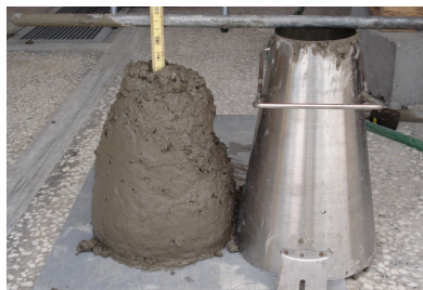
Φωτογραφία 6.1 Δοκιμή κάθισης.
