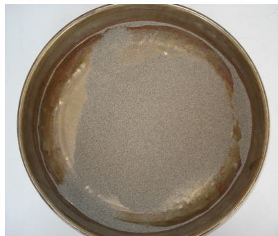
Φωτογραφία 8.12 Διερχόμενο βάρος από το κόσκινο 0,25 (παιπάλη)
