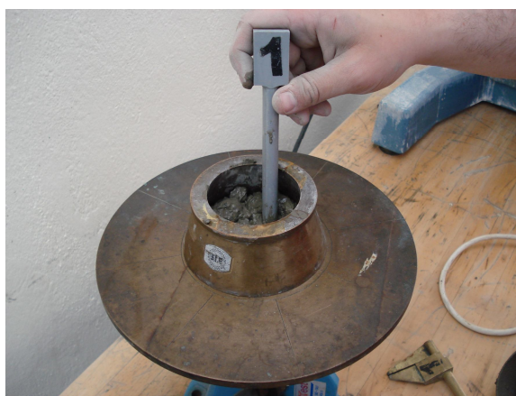
Φωτογραφία 8.25 Συμπύκνωση κονιάματος 1 ης στρώσης.
