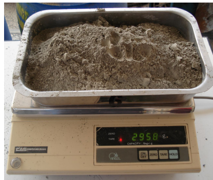
Φωτογραφίες 8.13 & 8.14 Ζύγιση παιπάλης λατομείου & τσιμέντου.
