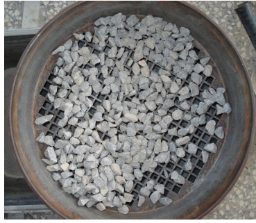
Φωτογραφίες 8.8 & 8.9 Συγκρατούμενο βάρος στα κόσκινα 16 & 8 (σκύρα & γαρμπίλι).
