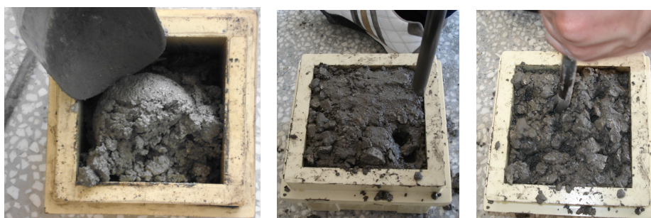
Φωτογραφίες 8.32 & 8.33 Γέμισμά της μήτρας με σέσουλα & συμπύκνωση 2 ης στρώσης με τη σχετική ράβδο.
