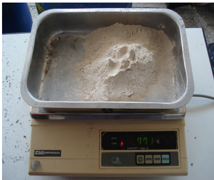
Φωτογραφίες 8.13 & 8.14 Ζύγιση παιπάλης λατομείου & τσιμέντου.
