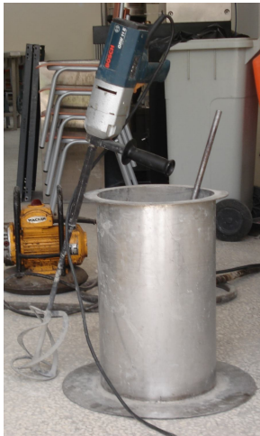
Φωτογραφίες 8.16 & 8.17 Αναμικτήρας & ξηρή ανάδευση αδρανών στο δοχείο.
