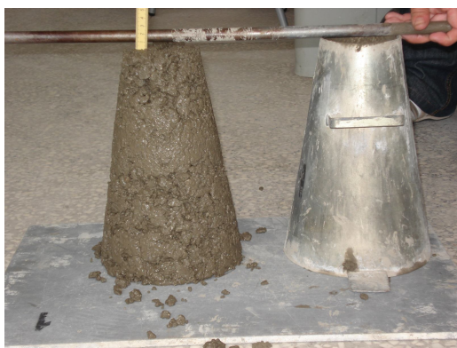
Φωτογραφία 8.22 & 8.23 Κάθιση 10 ης και 11 ης παρτίδας πριν & μετά την χρήση υπερρυστοποιητή.
