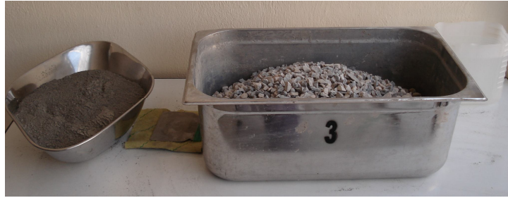
Φωτογραφία 8.15 Ποσότητα υλικών για 3 δοκίμια.
