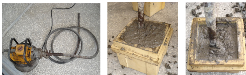
Φωτογραφίες 8.29 & 8.30 Συσκευή δονητή & συμπύκνωση με δονητή.
