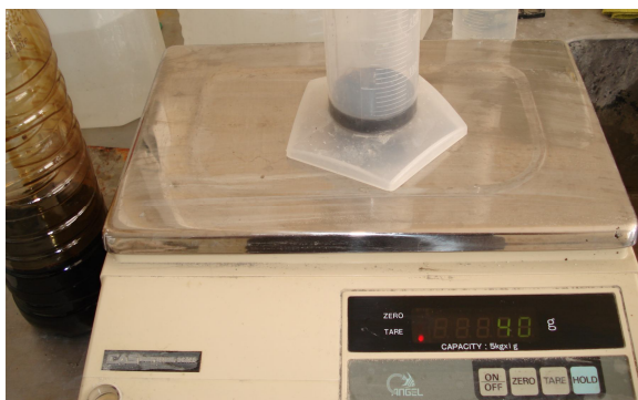
Φωτογραφία 8.5 & 8.6 Ζύγιση ποσότητας υπερρυστοποιητικού για 3 δοκίμια & ανάμιξη του με το νερό.
