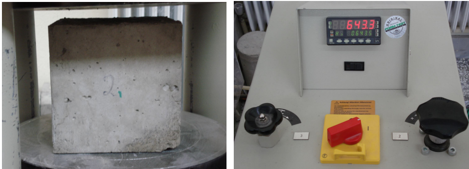
Φωτογραφίες 8.43 & 8.44 Τοποθέτηση δοκιμίου στη μηχανή θλίψης & αναπτυσσόμενη τιμή θραύσης.
