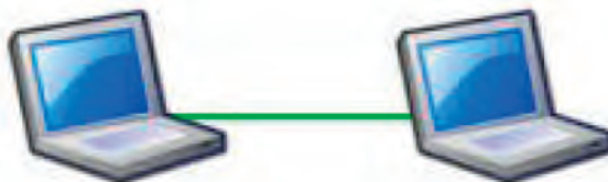
Σχήμα 5.14. Σύνδεση σταθμών με εξειδικευμένη σύνδεση (Ad Hoc).
