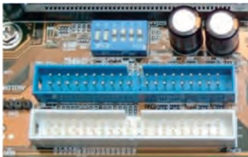
Εικ. 1.14. (α) Υποδοχές πρότυπου διασύνδεσης ATA/IDE, (β) Υποδοχές πρότυπου διασύνδεσης SATA .
