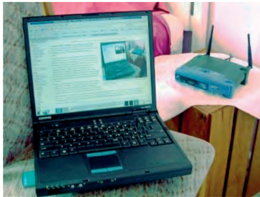
Εικ. 4.2. Ασύρματος σταθμός και ασύρματο σημείο πρόσβασης
