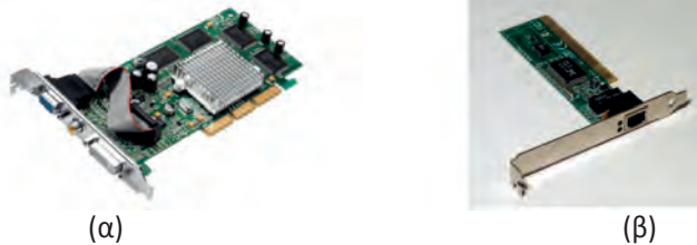
Εικ. 1.26. Κάρτες επέκτασης: (α) Κάρτα γραφικών τύπου AGP, (β) Κάρτα δικτύου τύπου PCI.
