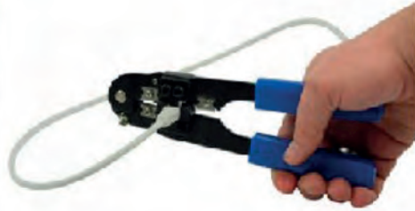
Εικ. 5.2. Βύσμα RJ45 (8P8C) και πρέσα για βύσματα RJ45.
