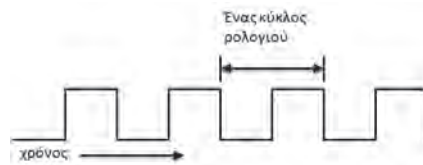
Σχ. 1.4. Περίοδος ή κύκλος του ρολογιού
