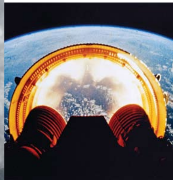
Αποχώρηση του δακτυλίου ένωσης πρώτου και δεύτερου ορόφου Saturn V.
