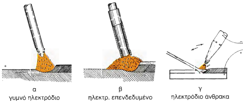
Εικ. 7.4β Συγκόλληση με ηλεκτρικό τόξο
