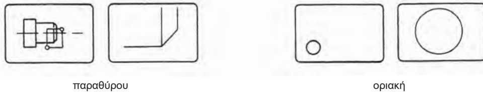
Σχ. 9.4.5β Είδη μεγέθυνσης σε συστήματα CAD
