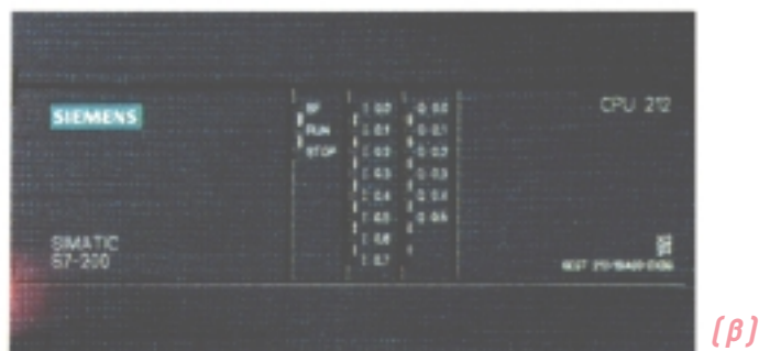
Σχήμα 1.3: (α) modular και (β) compact PLC
