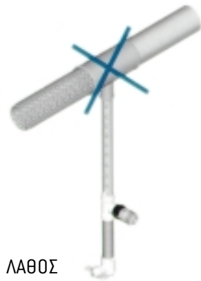
Σχήμα 14.2: Τρόπος λήψης παροχών από σωλήνες δικτύου αέρος
