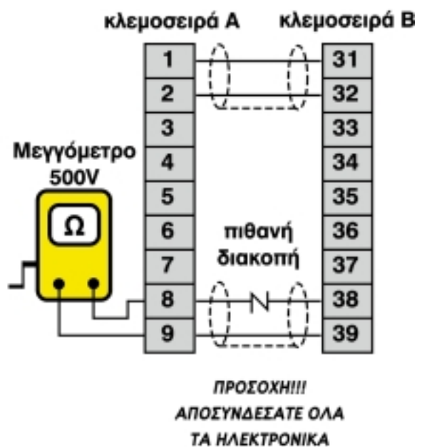
Σχήμα 24.15(β): Ανίχνευση πιθανής διακοπής με μεγγερόμετρο
