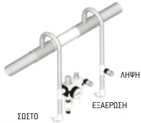
Σχήμα 14.2: Τρόπος λήψης παροχών από σωλήνες δικτύου αέρος
