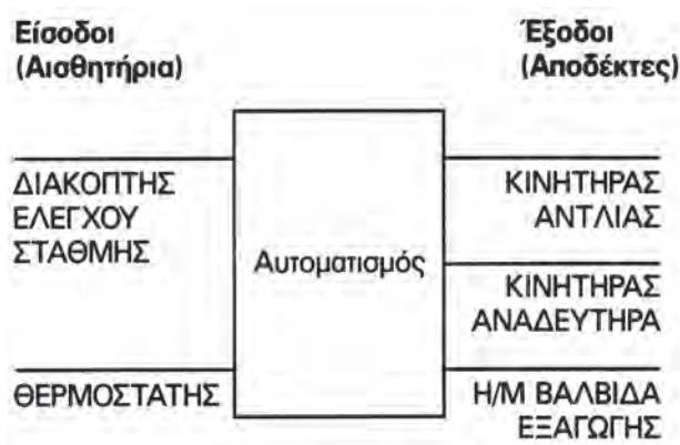
Σχήμα 2.58: Παράσταση του αυτοματισμού του σχήματος 2.57 ως σύστημα.
