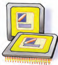
Εικόνα 2.3. Κεντρική Μονάδα Επεξεργασίας
