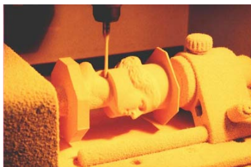
Εικόνα 134. Μηχανές τρισδιάστατης σμίλευσης ελεγχόμενες από Η/Υ
