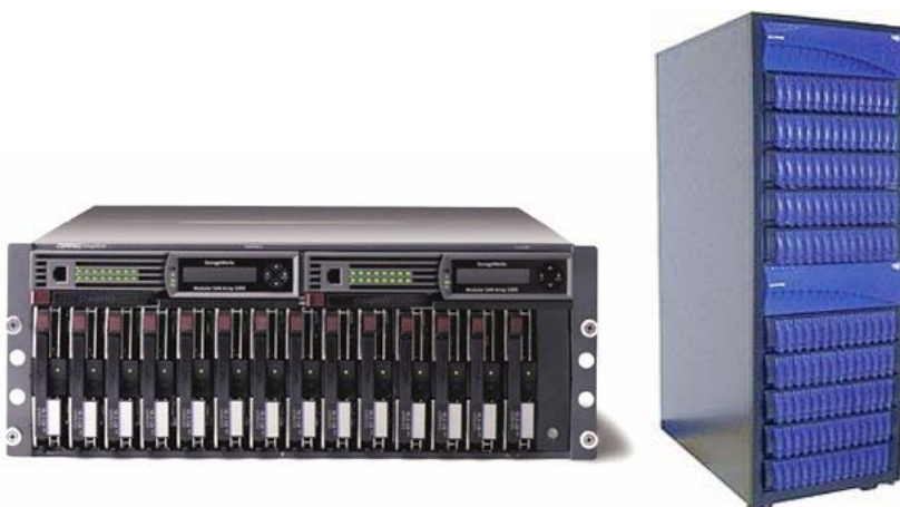
Εικόνα 115. Συστοιχίες μαγνητικών σκληρών δίσκων των 2 και 32 terabytes
