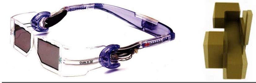
Εικόνα 127. Γυαλιά διαφράγματος υγρών κρυστάλλων και αντίστοιχη εικόνα
