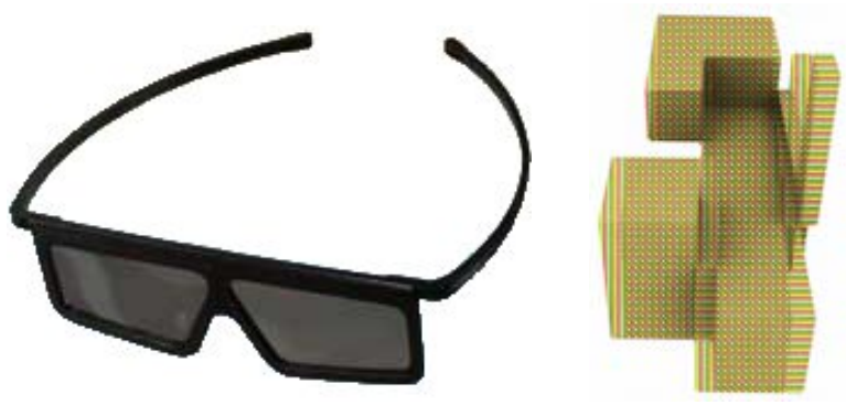
Εικόνα 126. Γυαλιά με αντίθετα πολωμένους φακούς και αντίστοιχη εικόνα
