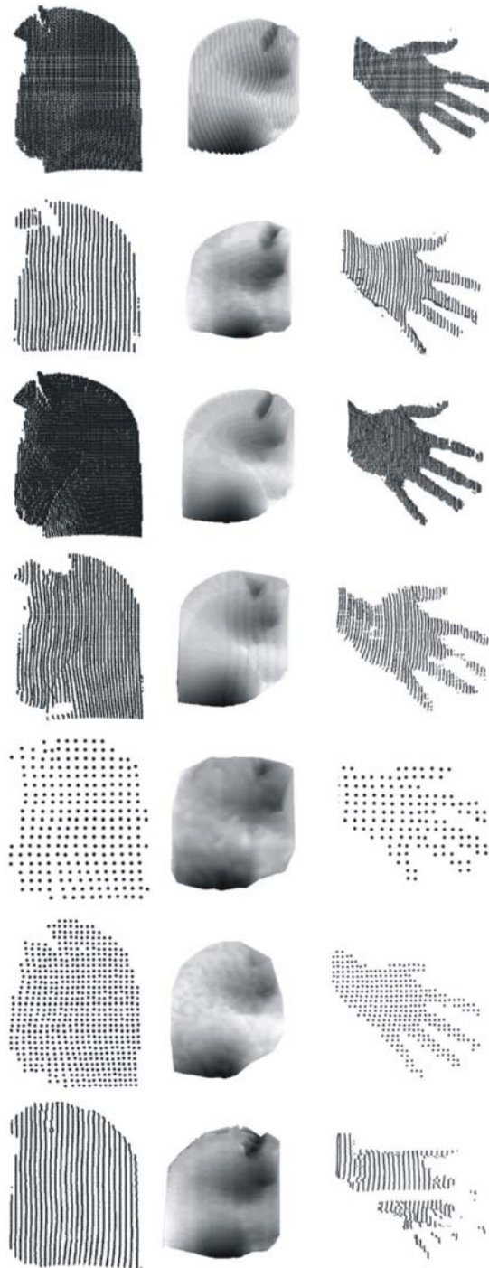
Εικόνα 44. Αποτελέσματα ανακατασκευής με διάφορες τεχνικές κωδικοποίησης μοτίβου δομημένου φωτός
