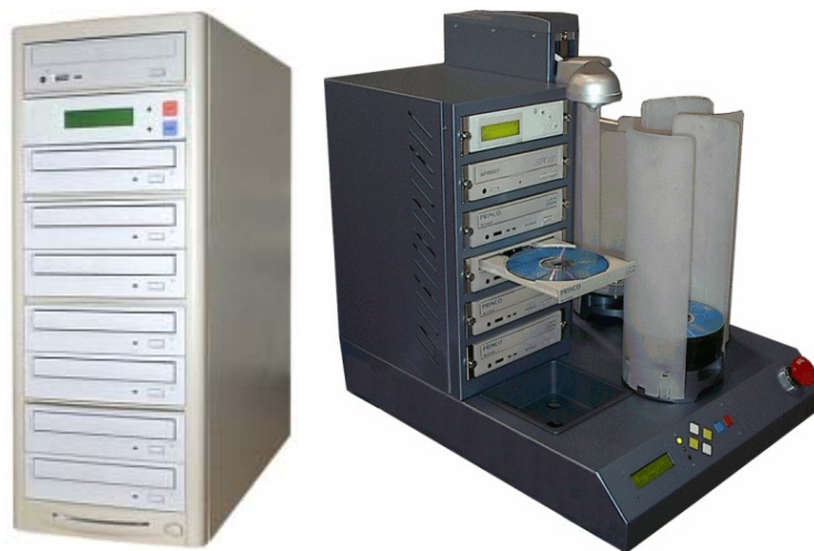
Εικόνα 131. Συσκευές μαζική αντιγραφής οπτικών δίσκων (CD/DVD) χειροκίνητης και αυτόματης (αριστερά και δεξιά αντίστοιχα) εναλλαγής των δίσκων
